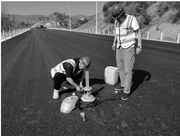
10月25日,在全国第47个质量月期间,三清路面标项目部精心组织路面渗水试验和路面平整度试验,确保路面平整度等各项性能达到最佳状态。(王英伟)
